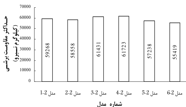
شکل ۱۷- نمودار حداکثر مقاومت برشی دیوار شماره ۲ در زیرمجموعه‌های مدل ۲
