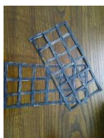
شکل ۱ - نمونه ژئوگرید به کار رفته در نمونه‌های آزمایشگاهی
